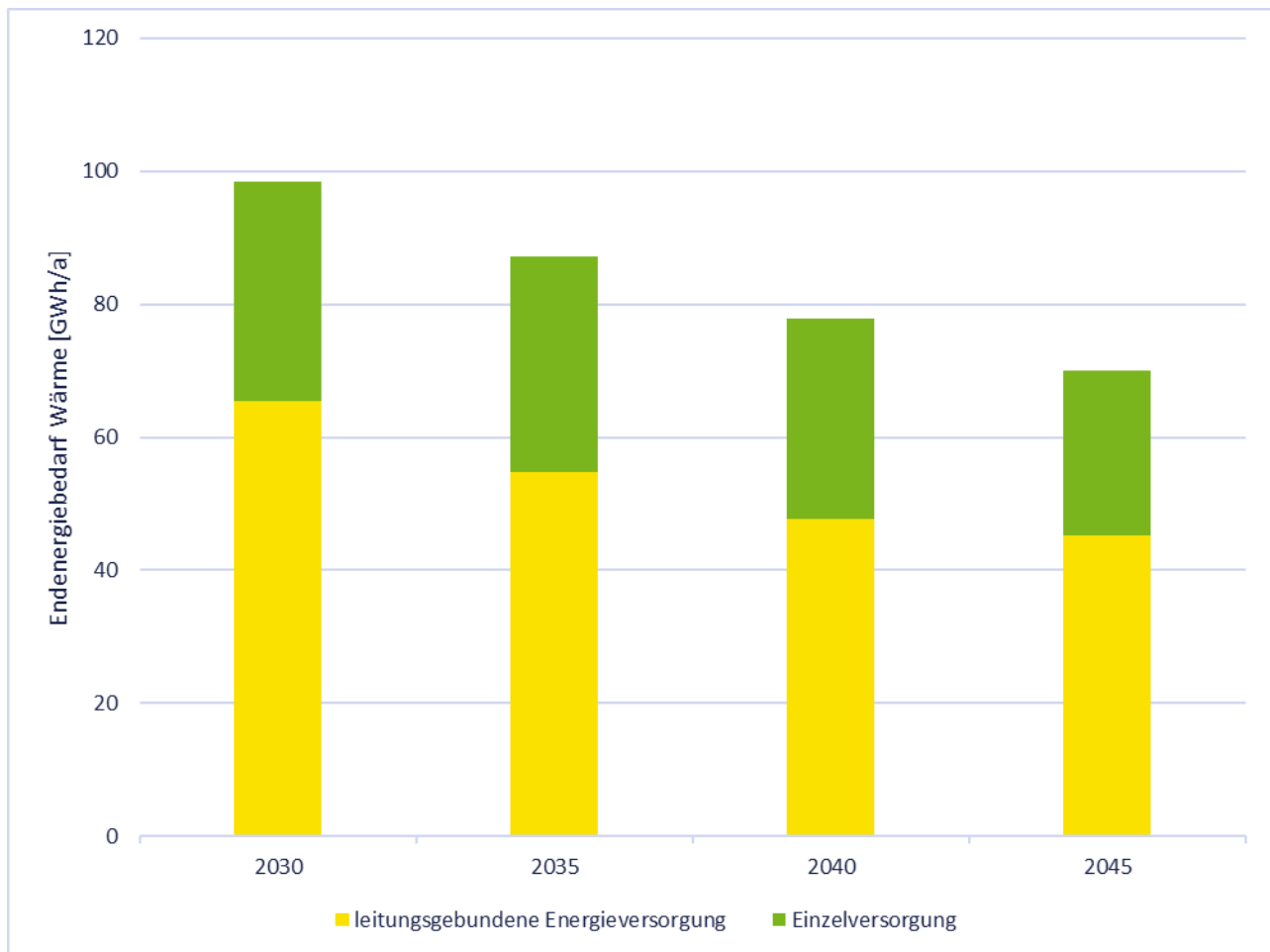
Abbildung 5-9: Anteil der Leitungsgebundenen Energieversorgung
