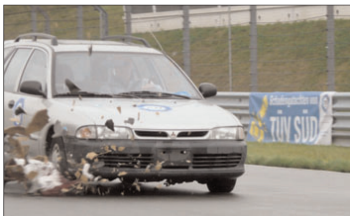
Statt eines echten zerbarst ein Keramiks Schwein beim Aufprall mit rund 70 km/h. Wenn stattdessen nur mit der geforderten Geschwindigkeit gefahren worden wäre, hätten Schwein und Auto in der Realität unbeschadet überstanden. Foto: Peter Kühnrich
